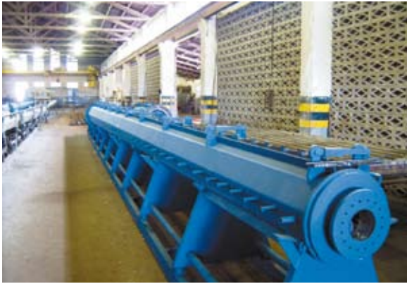
Moldes de Fábrica de columnas de hormigón
