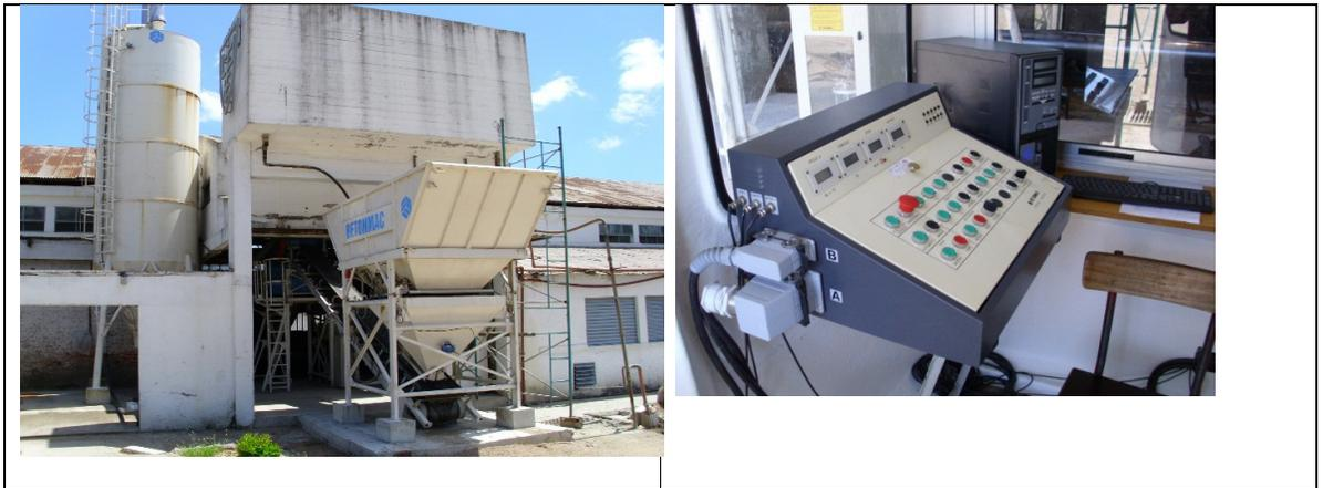
Se culminó la automatización de las autoclaves de impregnación de postes. El nuevo sistema evita errores humanos, facilita la tarea, permite el control remoto de los procesos y mejora la calidad de los postes que salen de la planta.
