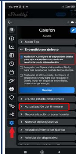
Queremos que ante un corte de energía imprevisto, el Shelly siempre arranque encendido. Nos paramos sobre el cuadro del enchufe. En la pantalla que aparece tocamos la ruedita y elegimos > Encendido Por Defecto. Marcamos la casilla que dice **Activado**.
