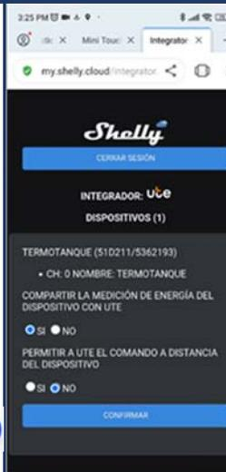
Luego, automáticamente se abrirá el sitio web de Shelly Cloud. Ingresaremos con el mismo usuario y contraseña que usamos en la app de Shelly. **Marcaremos SI solamente** al permiso *Compartir medición de energía*. **No olvidar tocar donde dice CONFIRMAR**
